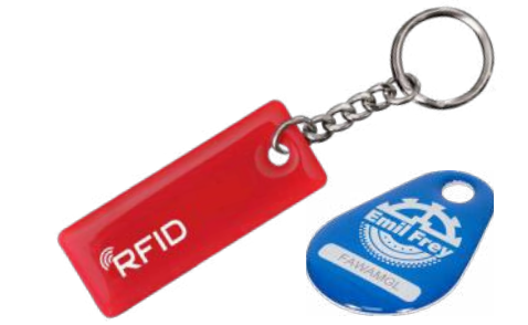
Porte-clé RFID en Résine Divers formats Technologie Mifare, NFC, EM4200, DESFire EV1, EV2, EV3 Fréquence 13.56 mhz, 125 Khz Numérotation et personnalisation possible
